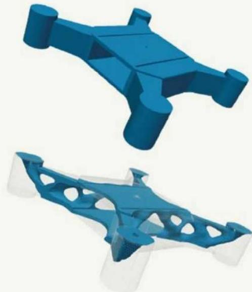
En el diseño de un dron se enfatiza la importancia de una adecuada distribución del material para mejorarlo y aligerar su peso. Arriba, Figura 1, abajo, Figura 2.
